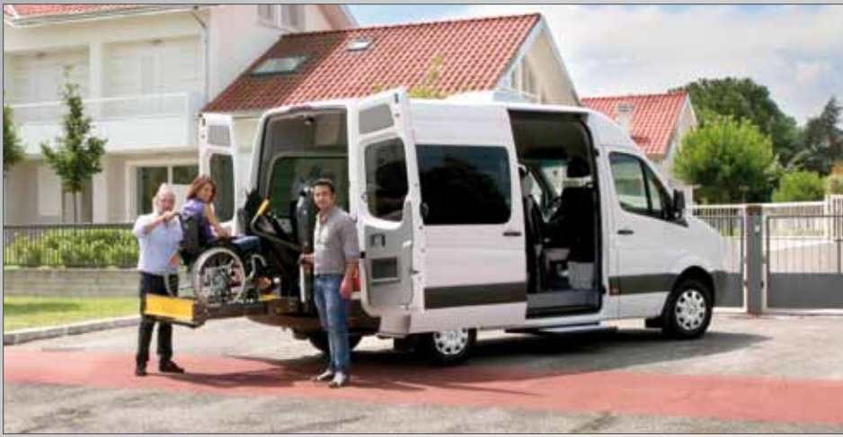
Mercedes Sprinter allestito con sollevatore Doppio Braccio
